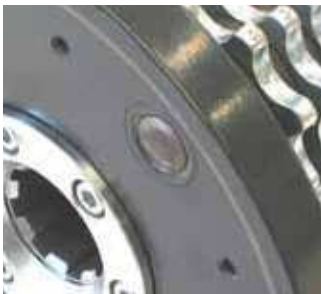
Mit Verschleißbuchsen = längere Lebensdauer
